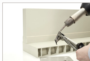
SPRÁVNÁ INSTALACE SVAŘOVACÍ HLAVY
